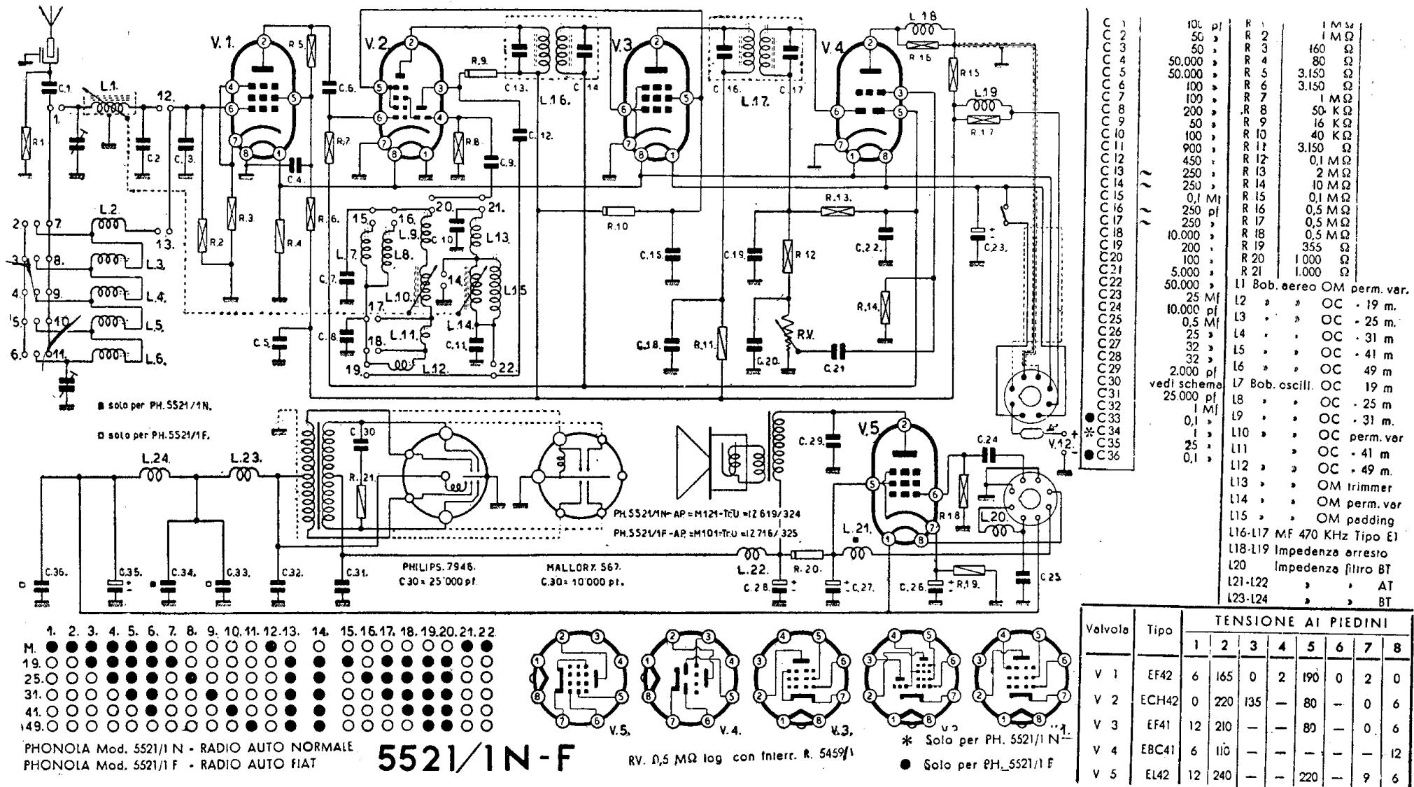
S.A. FIMI - Mod. PHONOLA 5521/1N e 5521/F - Apparecchi autoradio con vibratore sincrono (V. capitolo decimo). Gamma onde medie e cinque bande allargate a 49, 41, 31, 25 e 19 metri. Media frequenza 470 kc.
